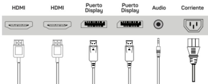
Conecte el cable de alimentación del monitor al puerto AC IN en la parte posterior del monitor.
