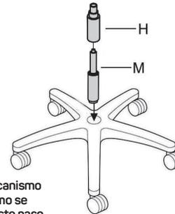
Alinear el mecanismo hidráulico como se muestra en este paso.
