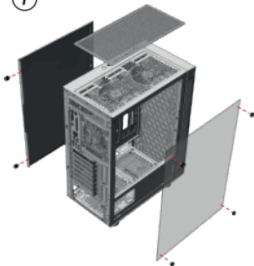
Para remover el panel de cristal templado desatornille los 4 tornillos en cada esquina, como se muestra arriba.
