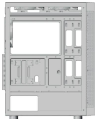
Dependiendo del modelo de tarjeta madre, deberá ajustar con los postes en los orificios faltantes para que la tarjeta sea bien colocada, estos deben ajustarse manualmente.
