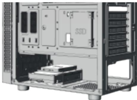
Coloque el disco de almacenamiento tipo HDD en el compartimiento como se ve en la imagen y atornille.
