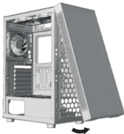
Instalación, remueva el panel del frontal colocando su mano debajo del panel y jalando con fuerza hacia usted.
