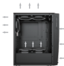
Para crear mejor corriente de aire, el aire debe provenir de enfrente y salir por la parte trasera superior
