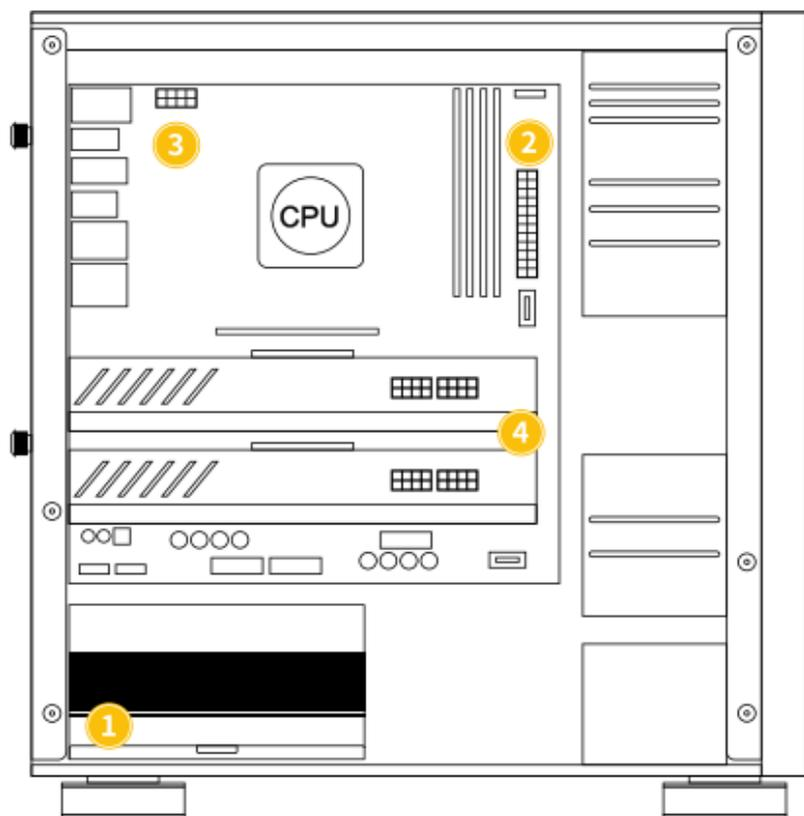
**5. Cable SATA, conectarla al disco duro que corresponda. El conector Molex, conectarlo a los equipos de ventilación.**
